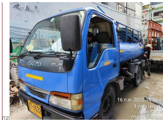
รูปที่ 32 การสูบล้างถังเก็บน้ำทิ้ง
